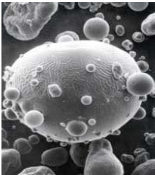
Рисунок 1 – Типичная частица сухого молока. Одноступенчатая сушка
