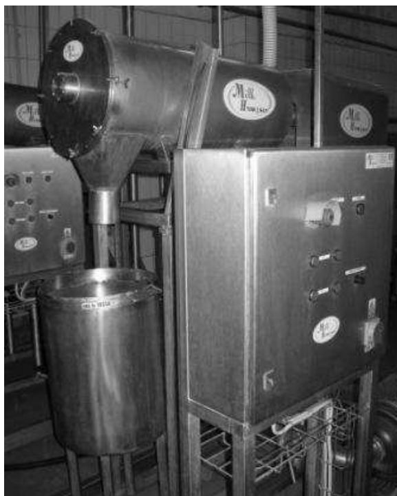
Рисунок 1 - Ротационный фильтр марки MilkHydrosan (Польша)
