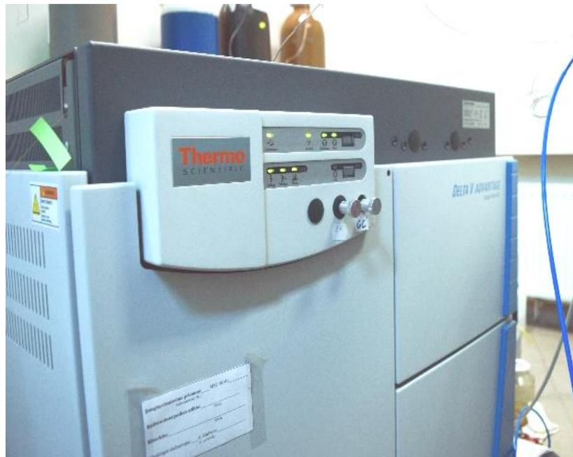
Рисунок 2 – Масс-спектрометр ThermoDeltaV Advantage (Государственный научно-исследовательский институт «Центр физических наук и технологий» (Литва)
