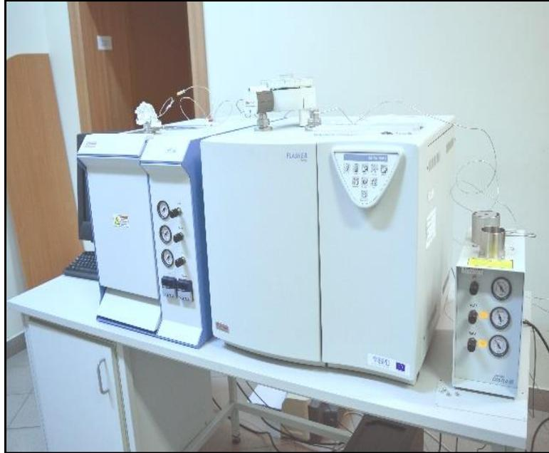
Рисунок 1 – Элементный анализатор ThermoFlash1112, подключенный к масс-спектрометру изотопного соотношения ThermoDelta V Advantage (Государственный научно-исследовательский институт «Центр физических наук и технологий» (Литва)
