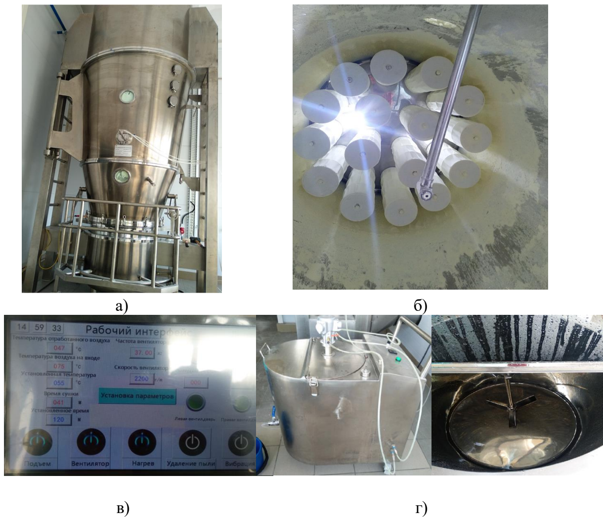
а) Агломерационная установка KFL-200; б) Пневмообстукиватели; в) Рабочий интерфейс; г) Емкость для приготовления сиропа.
