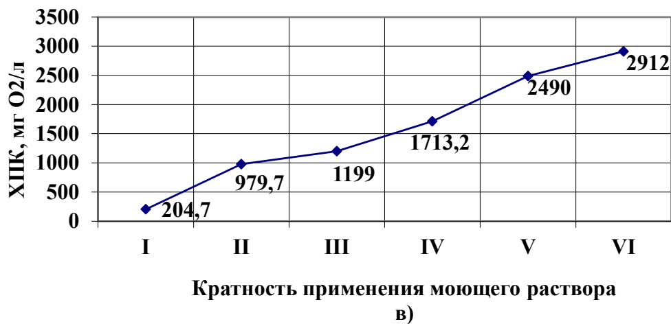
Рисунок 1 – Загрязнение моющего раствора в процессе мойки технологического оборудования: а) резервуаров сырого молока, б) вакуум-выпарной установки, в) технологическое оборудование стерилизованных молочных продуктов (кратность применения раствора: I – исходный; II-после 1-й мойки; III-после 2-й; IV-после 3-й; V-после 4-й; VI – после 5-й мойки)
