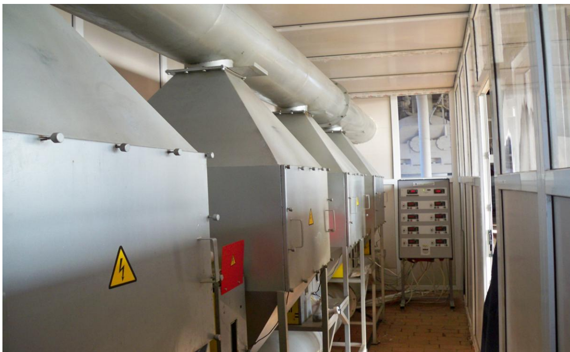
Рисунок 1 – Опытный образец установки Ш12-ЭРУОВ для очистки вентвыбросов при производстве сухих животных кормов
