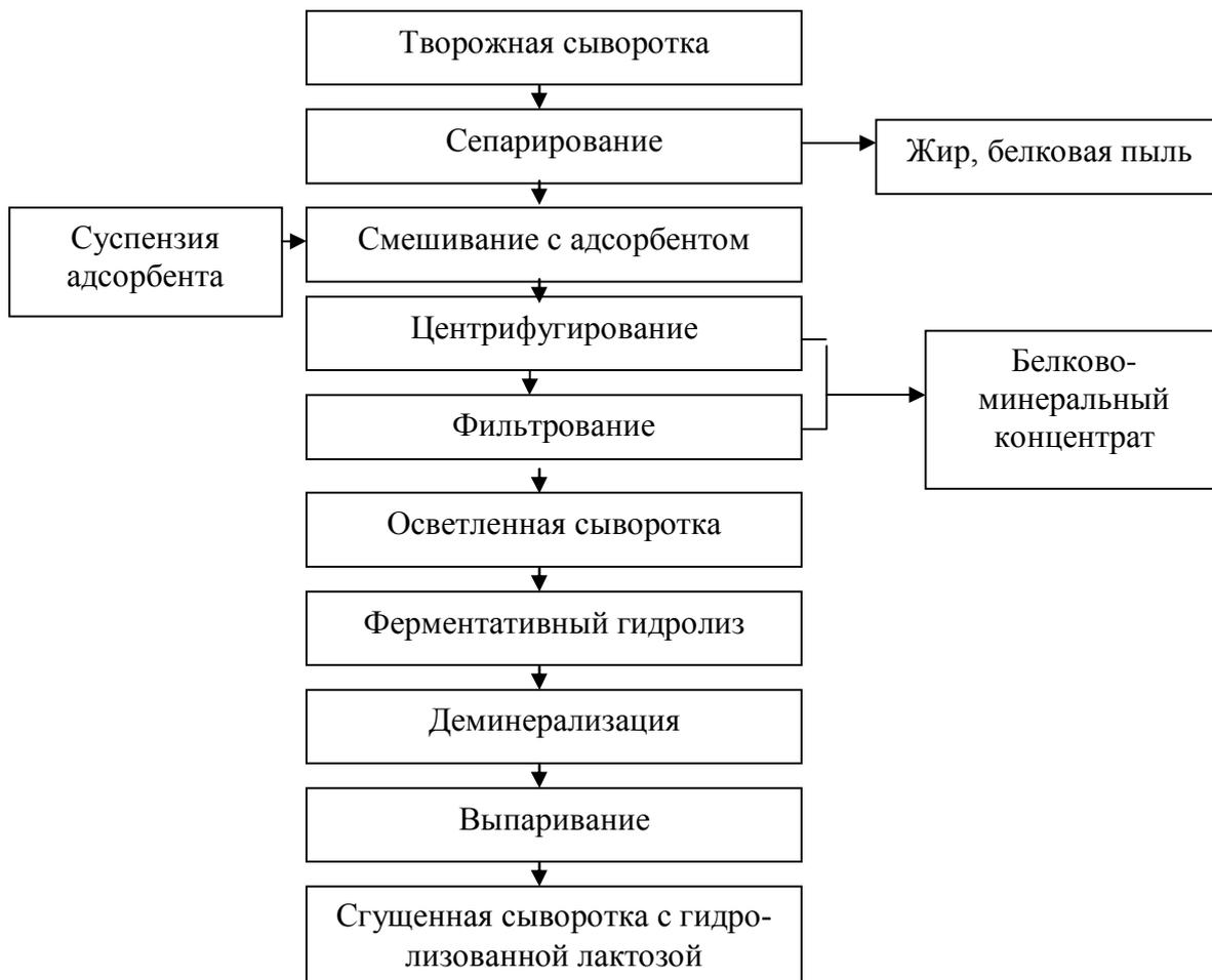
Рисунок 3 – Схема получения сыворотки с гидролизованной лактозой
