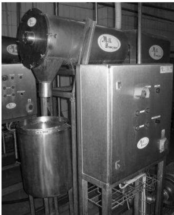
Рисунок 1 - Ротационный фильтр марки MilkHydrosan (Польша)
