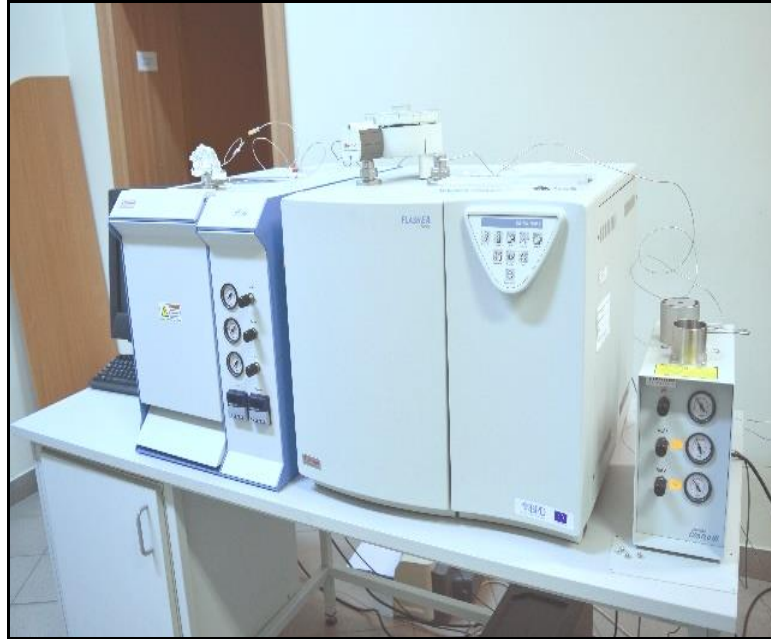
Рисунок 1 – Элементный анализатор ThermoFlash1112, подключенный к масс-спектрометру изотопного соотношения ThermoDelta V Advantage (Государственный научно-исследовательский институт «Центр физических наук и технологий» (Литва) Источник данных: собственная разработка.
