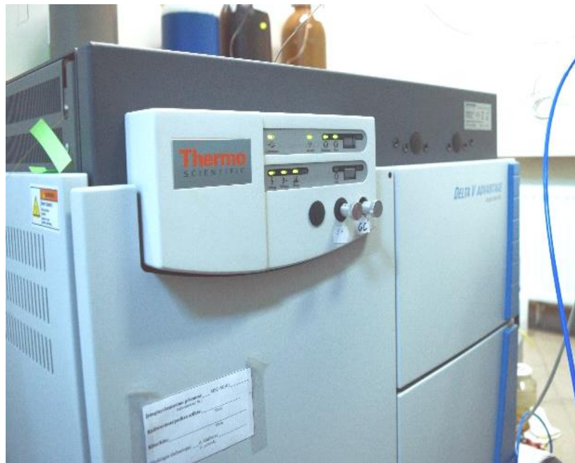
Рисунок 2 – Масс-спектрометр ThermoDeltaV Advantage (Государственный научно-исследовательский институт «Центр физических наук и технологий» (Литва) Источник данных: собственная разработка.
